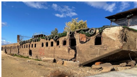
Нижняя часть плавучей ремонтной мастерской на берегу р.Оби (возле Музея истории русского быта). Останки железобетонной конструкции плавучей ремонтной мастерской. Август 2025 г.
