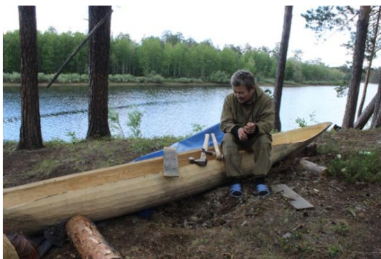
Рис. 2. Процесс изготовления ай рыт из ствола осины
